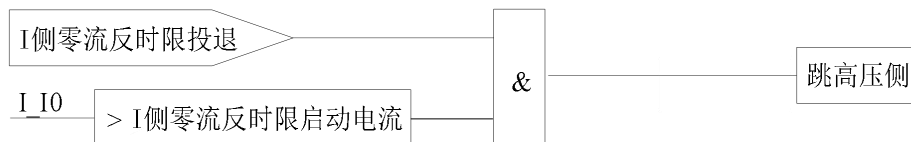
图 2.10 两段式零序过流/反时限过流保护逻辑
